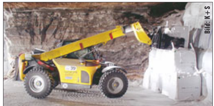
Kramers 4009 mit vier Tonnen Hubkraft und neun Meter Stapelhöhe unter Tage
