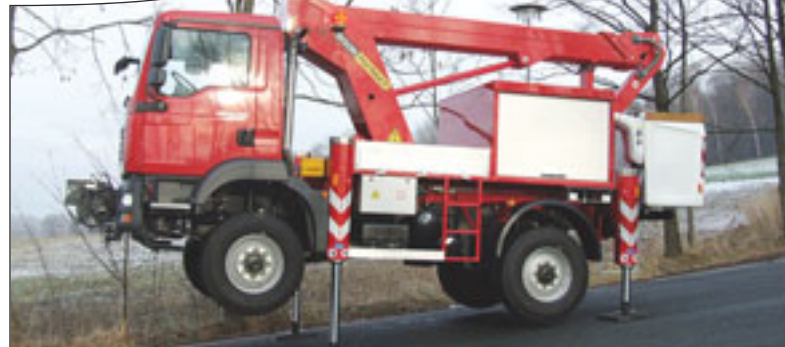
Palfinger bringt eine neue Serie auf den Markt. Niedrige Abstützbreite und hoher Stützenhub zeichnet die Geräte aus.
