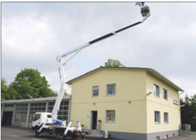
Die CTE Z 20E mit einem Gelenkpunkt bei acht Metern
