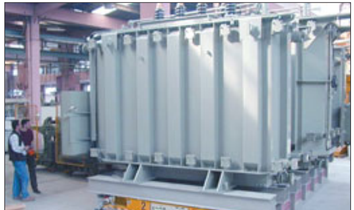
Die Transportplattform von Solving mit einem knapp 500 Tonnen schweren Trafo
