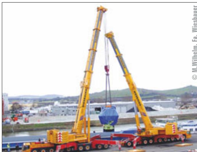
Seltener Tandemhub von zwei Terex Demag AC 700 der Firma Wiesbauer
