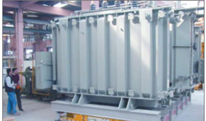
Die Transportplattform von Solving mit einem knapp 500 Tonnen schweren Trafo
