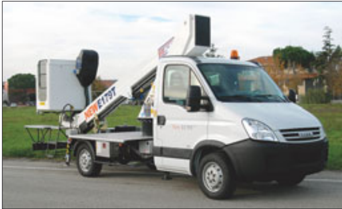
Die GSR E179T, aufgebaut auf einem Iveco Daily in der „Compact“-Version
