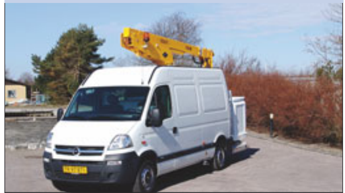
Time hat den Drehkranz bei seinen Kastenwagenaufbauten auf das Dach verbaut. Dadurch wird im Innenraum, wie bei dieser neuen ET-32-NF, Platz frei
