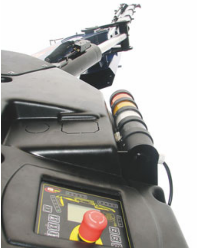
Die Power Tronic-Steuerung der PM-Krane
