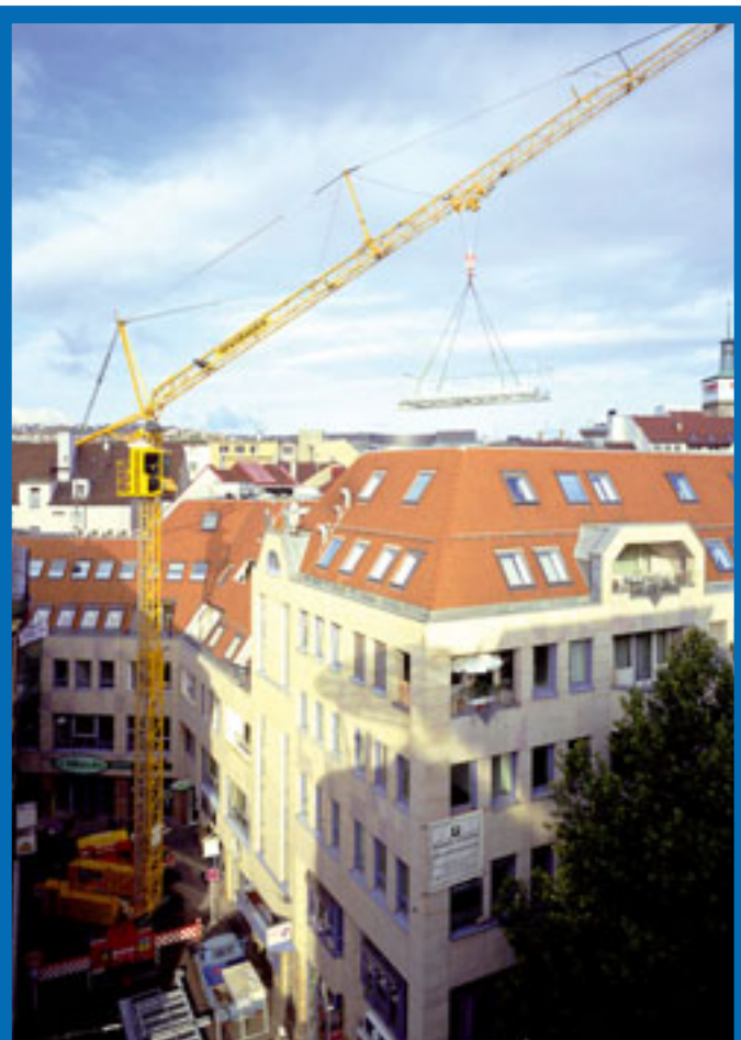
Wiesbauer hat als erster Kranbetreiber in Deutschland den neuen Liebherr MK 63 erhalten. Der neu konstruierte Taxikran punktet mit der 45°-Super-Steilstellung des Auslegers und erreicht so die in seiner Kranklasse einzigartige Hakenhöhe von 47,9 Metern. Bereits kurz nach seiner Auslieferung kam der Newcomer in der Innenstadt von Stuttgart mehrfach zum Einsatz, wie hier bei Umbauten im Areal der Stuttgarter Brauerei Dinkelacker.
