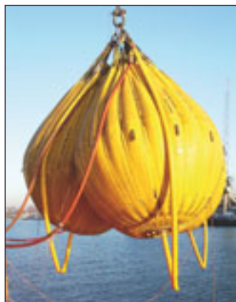
Ein Wassersack bringt es auf 35 Tonnen. Zur genauen Gewichtsfeststellung der Wassersäcke werden Loadcells eingesetzt.
