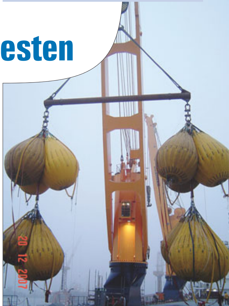
Ein Liebherr CBB 4200 mit 350 Tonnen Tragkraft im Overload-Test mit 385 Tonnen
