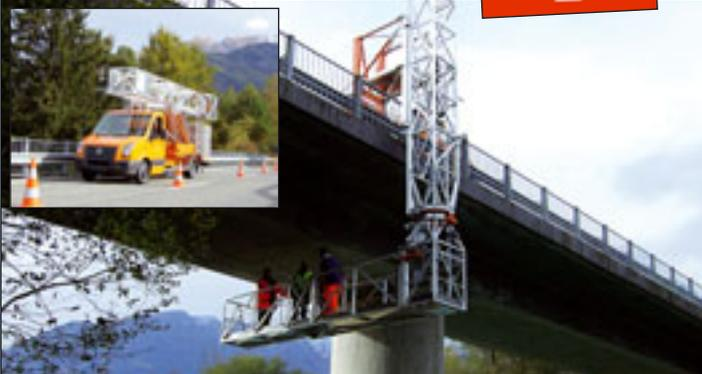
Ein neues Brückenuntersichtsgerät vom Typ Moog MBI / 70-1 S hat der Kanton Graubünden aus den Händen der Skycraft GmbH nach eintägiger Schulung in Empfang genommen. Die Maschine bietet eine Absenktiefe bis 6,5 Meter, eine maximale horizontale Reichweite von sieben Metern sowie eine von 400 Kilogramm. Abstützung und Drehkranz sind inner-
