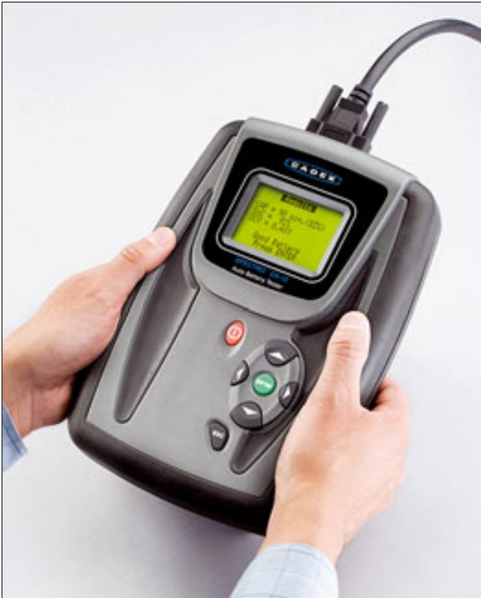
Spectro CA-12 löse altbekannte Probleme dieser Methode durch den Einsatz hochleistungsfähiger digitaler Signalprozessoren. Moderne Mikroelektronik hat Cadex in das kompakte Handgerät gepackt. Das Herz des Geräts jedoch ist sein patentierter Algorithmus, so
