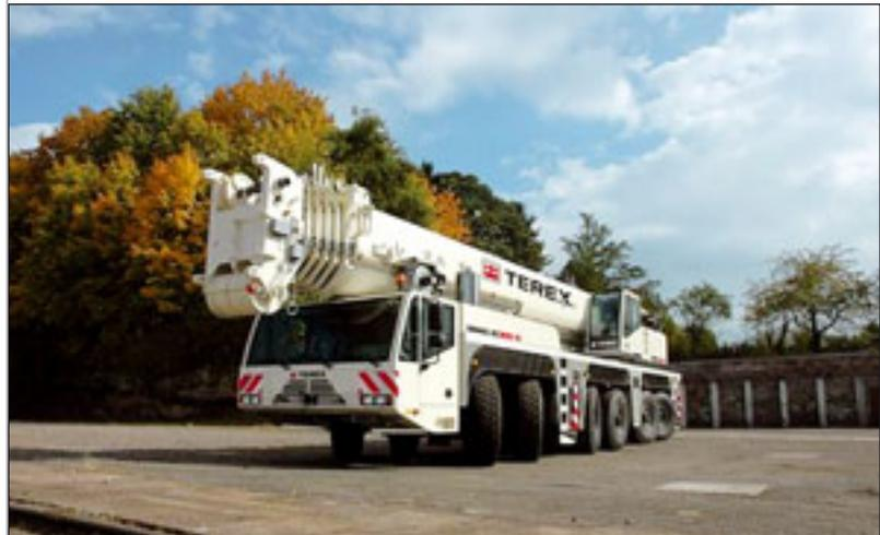
Aufgrund seiner Tragfähigkeit und seines maximalen Lastmoments von 951 tm sei der AC 300/6 „der stärkste Mobilkran seiner Klasse auf dem Markt“, sagt das Unternehmen. Mit seiner Neuentwicklung will Demag Akzente setzen: 64 Meter Hauptausleger, längste Systemlänge aller 6-Achser mit 125,7 Metern sowie Superlift für weitere Tragfähigkeitsverbesserungen bei großen Systemlängen.
