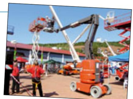
« Allerdings müssen diese in der Regel nie gewechselt werden, da es sich um Vollgummiräder handelt. Bei der Bodenfreiheit nimmt das Unternehmen die Achse als Messpunkt, nicht den eingeklappten Schlaglochschutz, der den niedrigsten Punkt markiert.
