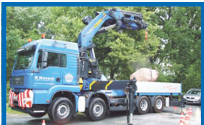
Zum Fuhrpark der Firma Knaack zählt ein neuer Palfinger-Ladekran des Typs 150002. „Mit dem PK 150002 sind völlig autark auch Aufträge durchführbar, für die sonst mit entsprechendem Aufwand am Be- und Entladeort ein Autokran organisiert werden müsste, so Karsten Knaack. Die K. Knaack Logistik & Transport GmbH hat ihren Sitz in Hollenstedt südwestlich von Hamburg und ist spezialisiert auf Schwertransporte in ganz Europa.“
