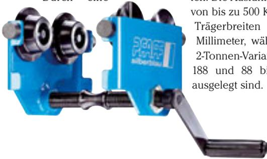
seitlich angebrachte Kurbel lässt sich die Traverse stufenlos auf verschiedene Trägerbreiten verstellen. Die Ausführung für Traglasten von bis zu 500 Kilogramm erlaubt Trägerbreiten von 50 bis 180 Millimeter, während die 1- und 2-Tonnen-Varianten auf 66 bis 188 und 88 bis 22 Millimeter ausgelegt sind.
