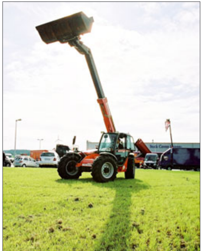
Manitou setzt auf Perkins-Motoren. Hier ein MLT 634-120 LSU Turbo, mit einem 123 PS starken Perkins Motor 1104C-44TA. Soll heißen: ein Motor aus der 1100-Serie mit 4 Zylindern, C: Emissionsstufe 2, mit 4,4 Litern Hubraum, Turbo und A: Ladeluft/Luftkühlung.
