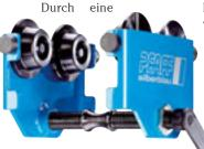
seitlich angebrachte Kurbel lässt sich die Traverse stufenlos auf verschiedene Trägerbreiten verstellen. Die Ausführung für Traglasten von bis zu 500 Kilogramm erlaubt Trägerbreiten von 50 bis 180 Millimeter, während die 1- und 2-Tonnen-Varianten auf 66 bis 188 und 88 bis 22 Millimeter ausgelegt sind.
