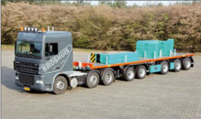
Der niederländische Hersteller Broshuis hat einen leichtgewichtigen, teilbaren Ballastauflieger präsentiert. Der neue Auflieger ist ein 5-Achser, der in zwei kurze Einheiten geteilt werden kann, ein 2-achsiges und ein 3-achsiges Teil. Diese kurzen Einheiten bieten den Vorteil, dass sie leicht zu rangieren sind.
