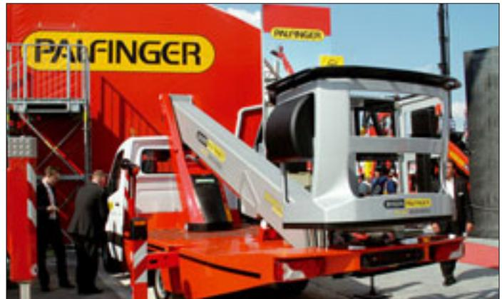
Bison Palfinger hat das erste Modell der neuen TA-Baureihe vorgestellt, die TA 25 Business. Das neue Modell mit 24,5 Metern Arbeitshöhe auf 3,5-Tonnen-Chassis überrascht mit einigen Details. So besteht die Plattform, die den Unterwagen abdeckt, aus einem neuen Glasfaserverbund-Werkstoff. Eine seitliche „Wendeltreppe“ führt jetzt bequem auf die Plattform und von dort aus in den Korb.
