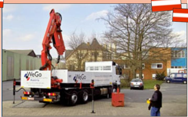
Die Wiener Niederlassung der Firma WeGo Systembaustoffe übernahm jetzt den ersten Baustoffkran von Tirre Krantechnik. Der Euro 222 hat einen sechsfach hydraulischen Ausschub und bietet damit an die 19 Meter effektive Reichweite. Die Vierpunktstützung des Fahrzeuges bringt Stabilität bei Arbeiten in großen Höhen. WeGo Systembaustoffe ist ein
