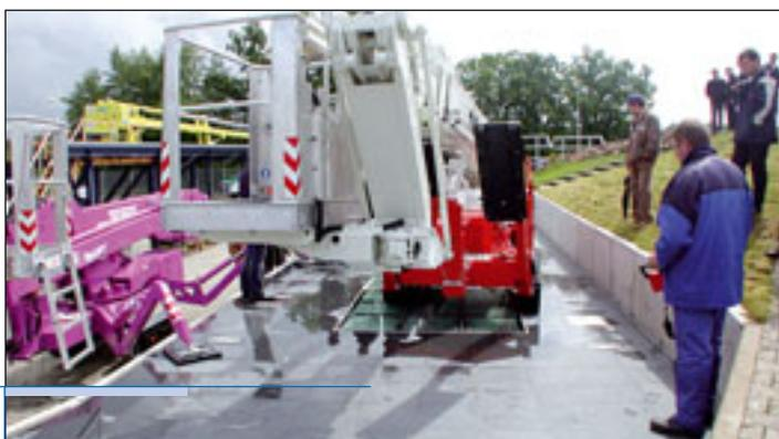
Mit der LKW-Bühne T 580 rundet das münsterländische Unternehmen seine Palette im oberen Bereich der im Herbst 2004 eingeführten T-Baureihe ab. Vierfach-Unterarm-Teleskop, Einfach-Oberarm-Teleskop und Korbarm sollen optimale Auslegerbeweglichkeit ermöglichen. Alles aufgebaut auf einem Standard-3-Achser. Solche Leistungsdaten waren bisher, so das Unternehmen, nur auf 4-Achs-Fahrgestellen möglich.
