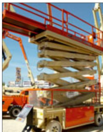
Mit der Liftlux-Serie geht es bei JLG hinauf bis auf 34 Metern Arbeitshöhe
