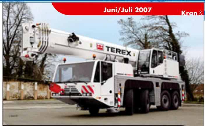
Jüngster Mobilkran von Terex Demag ist der AC 100/4
