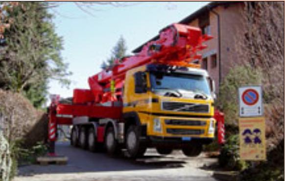
Seit über einem halben Jahr ist der größte Montagekran der Schweiz im erfolgreichen Einsatz. In der Anwendung füllt das Gerät eine Nische aus zwischen dem großen Stückgutkran und dem Mobilkran. Der seit 2006 in den Diensten der Firma Meiko, Root LU stehende MKG-Montagekran 991 HPT a3a3
