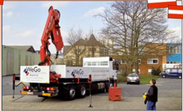
Die Wiener Niederlassung der Firma WeGo Systembaustoffe übernahm jetzt den ersten Baustoffkran von Tirre Krantechnik. Der Euro 222 hat einen sechsfach hydraulischen Ausschub und bietet damit an die 19 Meter effektive Reichweite. Die Vierpunktstützung des Fahrzeuges bringt Stabilität bei Arbeiten in großen Höhen. WeGo Systembaustoffe ist ein
