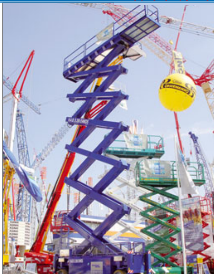
Das Kürzel verrät es: Die S 280-12 E4WDS verfügt über eine Baubreite von 1,2 Meter und eine Arbeitshöhe von 28 Metern
