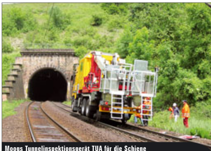
Moogs Tunnelinspektionsgerät TUA für die Schiene
