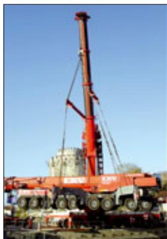
Dort kommen drei Krane von Terex Demag zum Einsatz: ein AC 700, ein AC 650 sowie ein AC 350. Aufgabe war die Zusammensetzung einer Tunnelbohrmaschine mit einer Länge von 106 Meter und einem Gesamtgewicht von 1000 Tonnen. Das Besondere: Der AC 350 und der AC 650 wurden für die Montagearbeiten
