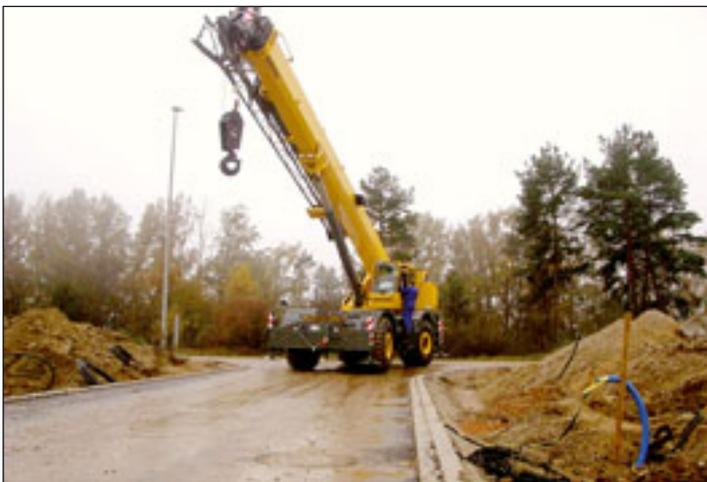
Ein geländegängiger Mobilkran vom Typ RT875E befindet sich im Langzeiteinsatz in Deutschland beim Netzaberg-Projekt. Der RT-Kran verfügt über einen vierteiligen Hauptausleger von 39 Meter Länge und eine maximale Hakenhöhe von 71 Metern (mit Erweiterung). Er wird 16 Monate lang bei der US-Armee im ostbayerischen Grafenwöhr eingesetzt. Zur Zeit hilft die Maschine beim Zusammenbau von Fertigteilen für 835 Häuser in der so genannten Netzaberg Housing Area.
