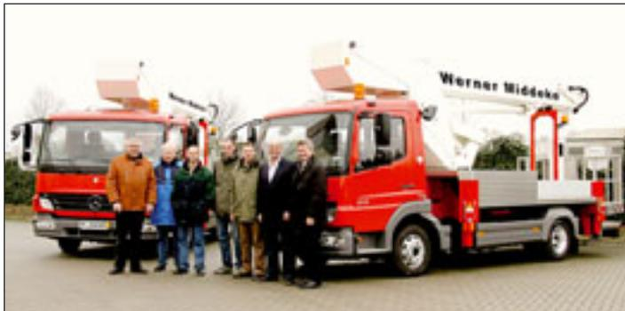
Der Hubarbeitsbühnenvermieter Werner Middeke aus Erwitte bei Paderborn hat zwei Ruthmann LKW-Bühnen vom Typ T 270 in Empfang genommen. Die T 270 bietet eine Arbeitshöhe von 26,40 Metern und eine Reichweite von 20,40 Metern. Ausgestattet mit dem variablen Turm, können auch Hindernisse wie Vordächer mühelos überwunden werden.
