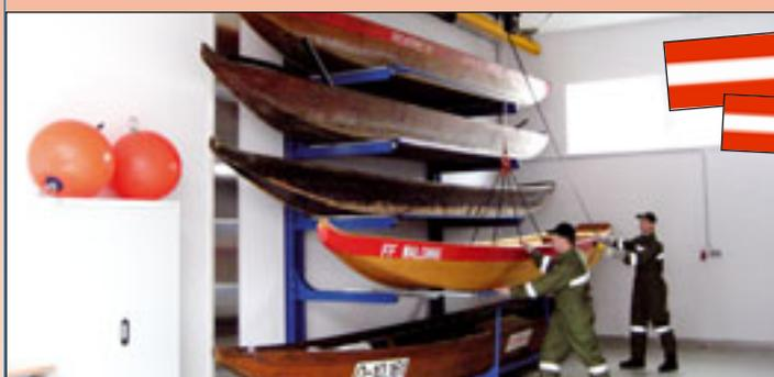
Die Wasserwehr der Freiwilligen Feuerwehr Walding in Oberösterreich konnte in ihrem Gerätehaus ein System zur raumsparenden Lagerung der Einsatzboote in Betrieb nehmen. Konzipiert und realisiert wurde das Projekt von einigen Kameraden der Wehr sowie der Ingenia Krantechnik aus St. Florian. Das eingesetzte Leichtkransystem „Profile-Master“ lieferte der Mannheimer Hebezeugspezialist SWF Krantechnik.
