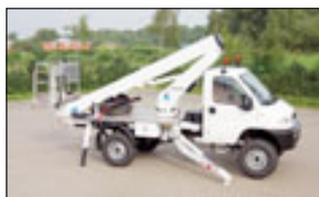
Der TB 220 kommt in einer Offroad-Variante daher: ein geländegängiges SCAM-Allradfahrzeug dient als Unterwagen. Die zehntausendste
