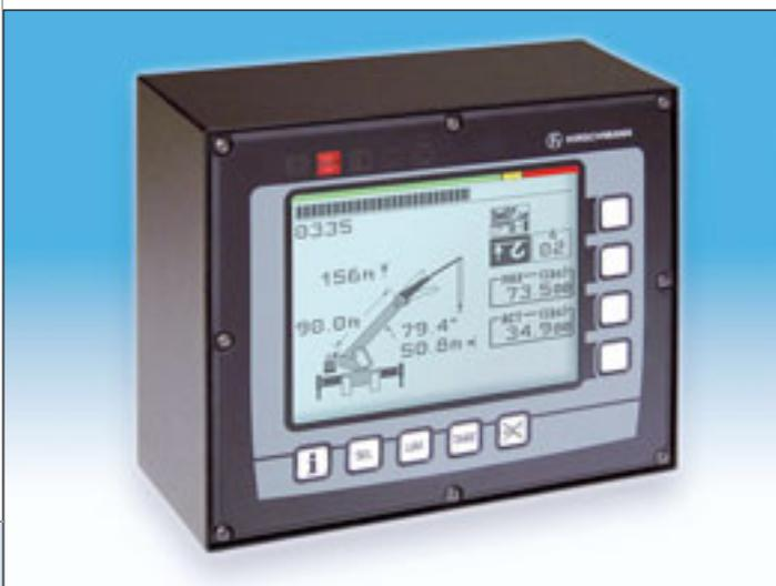
Das neue Lastmomentbegrenzungssystem „mentor QVGA“ von Hirschmann bietet eine grafische Darstellung sämtlicher Applikationsdaten auf einem 320 x 240 Pixel großen Display. Das Lastmomentbegrenzungssystem besteht aus einer Bedienkonsole und einer elektronischen Steuerungseinheit, die in einem kom-
