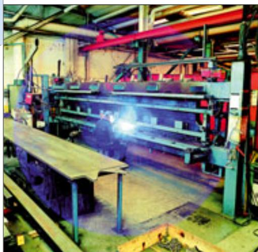
SSAB Oxelösund und AGA-Linde haben ein so genanntes „Rapid Processing“-Verfahren zum Schweißen hochfester Stähle entwickelt. Die Schweißgeschwindigkeit kann den Angaben zufol-
