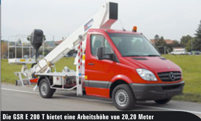
Die GSR E 200 T bietet eine Arbeitshöhe von 20,20 Meter
