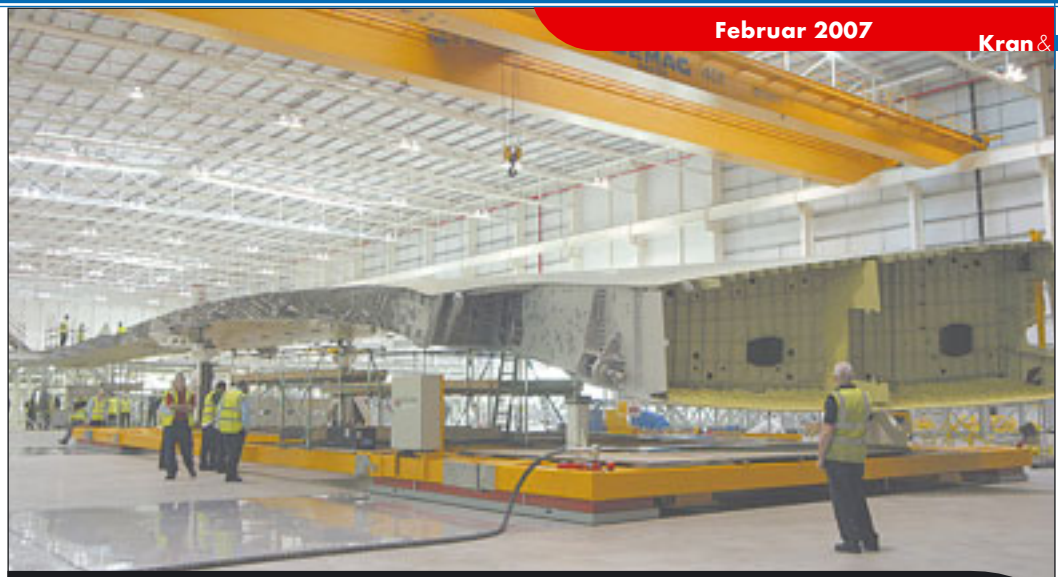
Solving transportiert Flugzeug-Tragflächen per Luftkissen
