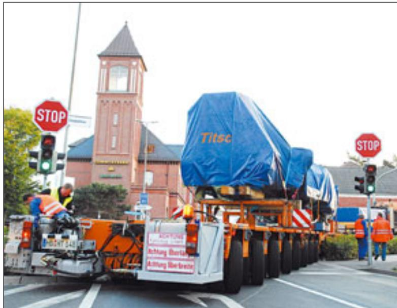
Die Bremer Schwerlastspedition Titschkus erhielt den Auftrag, eine 160 Tonnen schwere Anlage vom Hersteller zum Airbus-Werk in Nordenham zu liefern. Auf der 60 Kilometer langen Strecke kam eine 16-achsige Schwerlastkombination von Goldhofer zum Einsatz. Der Zug
