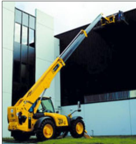
Arbeitsbühne ausgerüstet. Die Übermittlung von Signalen auf die Auslegerhydrauliksteuerung erfolgt von der Arbeitsbühne per Fernsteuerung auf die elektrohydraulischen Steuerventile. Gesteuert werden unter anderem die Funktionen Heben, Senken, Ein- und Austeleskopieren sowie der Hydraulikantrieb für Anbaugeräte.
