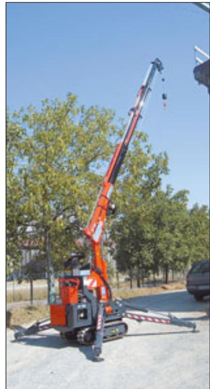
Einem Minkran des Typs 350E4 von Kegiom ist vor kurzem an die Robert Bosch GmbH ausgeliefert worden. Der 75 Zentimeter breite Minikran ist mit Fernsteuerung und Elektromotor ausgestattet.
