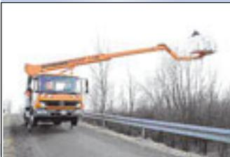
Mit der S-Variation bringt Ruthmann für seine T-Baureihe von 18 bis 30 Meter Arbeitshöhe eine alternative Abstützmöglichkeit auf den Markt. Die Geräte sind mit Senkrecht-Stützen ausgestattet, die nur innerhalb der Fahrzeugkontur abstützen. Das Gerät ist dank angeflanschten Stützen automatisch immer innerhalb der Fahrzeugbreite abgestützt.
