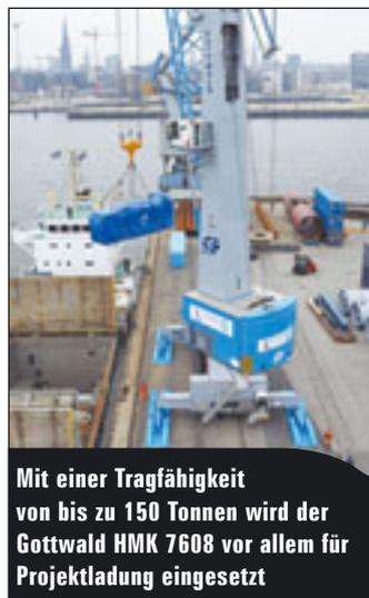
Mit einer Tragfähigkeit von bis zu 150 Tonnen wird der Gottwald HMK 7608 vor allem für Projektladung eingesetzt
