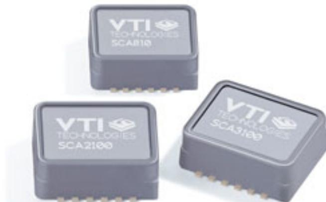
Der Trend in der Automobilelektronik hin zur smarten Integration und zu ‚intelligenten‘ Selbsttest-Funktionen hält ungebremst an. Eine neue digitale Sensorplattform für Fahrzeuge stammt von VTI Technologies. Dieser Sensor misst Beschleunigung und Neigung für elektronische Stabilitätssysteme (ESP) und damit verbundene Systeme wie HSA (Hill Start Assistant), EPB (Electronic Parking Brake), RSC
