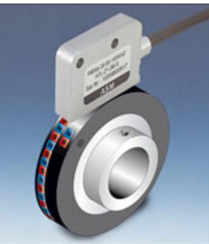
Speziell für rotative Anwendungen hat die Firma ASM magnetisch arbeitende Positionssensoren entwickelt. Erstes Mitglied der Produktfamilie „Posirot“ sind die magnetischen inkrementellen Winkelsensoren PMIS4/PMIR4. Bis zu 184.320 Pulse pro Umdrehung zeichnen dieses Messsystem aus. Sie sind sehr unempfindlich gegen Verschmutzungen zum Beispiel durch Öl oder Staub und somit für den Einsatz in rauer Industrieumgebung gut geeignet. Sie arbeiten bei Temperaturen von -40 bis +85 Grad Celsius.
