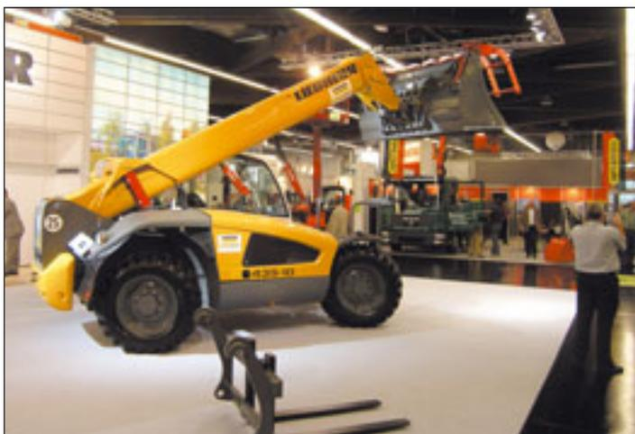
Liebherr tritt mit seinem Teleskoplader TL 435-13 früher an die Öffentlichkeit, als zunächst angekündigt. Sowohl auf der Nordbau als auch auf der GaLaBau war das Erstlingswerk der neuen Sparte zu bestaunen. Markant am 13-Meter-Gerät mit 3,5 Tonnen Tragkraft ist sein aus dem AT-Kran-Bereich stammender halbrunder Ausleger.
