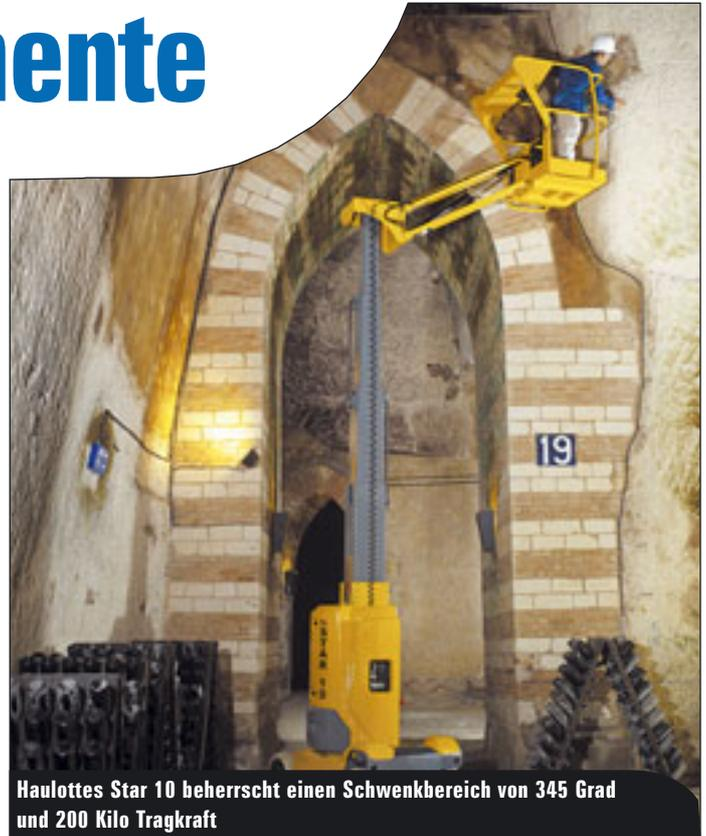
**Haulottes Star 10 beherrscht einen Schwenkbereich von 345 Grad und 200 Kilo Tragkraft**
