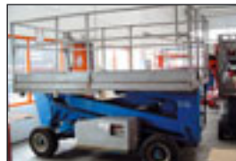
Scherenbühne Genie V2470, Bj: 1997 , Arbeitshöhe: 9,30 m, Korbmaße: 3,35x1,78 m, Hublast: 550 kg, Gewicht: 2.500 kg, Batterie, ausschieb. Plattform.
