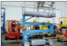
Scherenbühne Upright SL20, Bj: 1996 , Arbeitshöhe: 8,10 m, Korbmaße: 2,53x0,74 m, Hublast: 300 kg, Gewicht: 1.330 kg, Batterie, ausschieb. Plattform.
