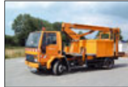
LKW-Bühne Ruthmann T130 auf Volvo FL 6 11, Bj: 1986 , Arbeitshöhe: 15 m, seilf. Reichweite: 11 m, Korbmaße: 1,60x0,80 m, Hublast: 250 kg, Gewicht: 8.000 kg, Diesel, hydraul. Stützen.
