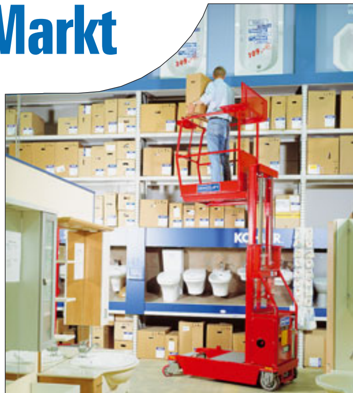
Die Kuli KBE 5 bietet sich insbesondere für Wartungszwecke sowie Beschickung und Entnahme von Artikeln aus Regalsystemen an
