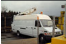
LKW-Bühne Versalift Eurotel 36 NF auf Iveco 35E, Bj: 1999 , Arbeitshöhe: 13,40 m, seilf. Reichweite: 7,20 m, Korbmaße: 1,20x0,68 m, Hublast: 200 kg, Gewicht: 3.700 kg, Diesel, Kastenwagen.
