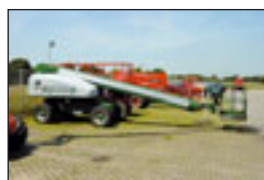
Teleskopbühne Condor T60, Bj: 1999 , Arbeitshöhe: 20,30m, Korbmaße: 1,80x0,90 m, Hublast: 227 kg, Gewicht: 9.200 kg, Diesel, Allrad, drehbarer korb.
