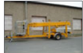
Anhängerbühne Omme Lift 1850 EBZ, Bj: 1998 , Arbeitshöhe: 18,50 m, seilf. Reichweite: 11,70 m, Korbmaße: 1,25x0,80 m, Hublast: 200 kg, Gewicht: 2.180 kg, Batterie, hydraul. Stützen.
