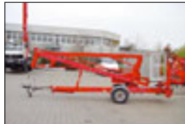
Anhängerbühne Litra 120 G, Bj: 2000 , Arbeitshöhe: 12 m, seilf. Reichweite: 4,50 m, Korbmaße: 1,05x0,66 m, Hublast: 215 kg, Gewicht: 1.200 kg, 220 V, hydraul. Stützen
