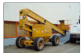
Gelenkteleskopbühne Grove AMZ 68 XT, Bj: 1997 , Arbeitshöhe: 21 m, Korbmaße: 2,50x0,76 m, Hublast: 265 kg, Gewicht: 10.980 kg, Diesel, drehbarer Korb.
