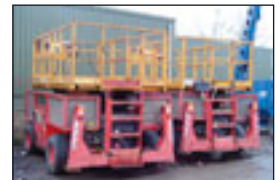
Scherenbühne Grove SM 3884 XT, Bj: 1997 , Arbeitshöhe: 11,90m, Korbmaße: 3,64x1,90m, Hublast: 567 kg, Gewicht: 5.250 kg, Diesel, Allrad, verschiebb. Plattform.
