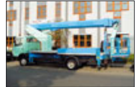
LKW-Bühne Ruthmann T 245 auf MB 814, Bj: 1995 , Arbeitshöhe: 26 m, seilf. Reichweite: 17,50m; Korbmaße: 1,70x1,00 m, Hublast: 265 kg, Gewicht: 7.490 kg, Diesel, H-Stützen, Korbarm.
