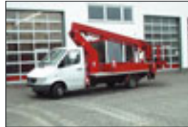
LKW-Bühne Ruthmann TL140 auf MB 308, Bj: 1995&96 , Arbeitshöhe: 16,00 m, Korbmaße: 1,20x0,68 m; seilf. Reichweite: 11,70 m, Hublast: 200 kg, Gewicht: 3.240 kg, Diesel, 220 V im Korb
