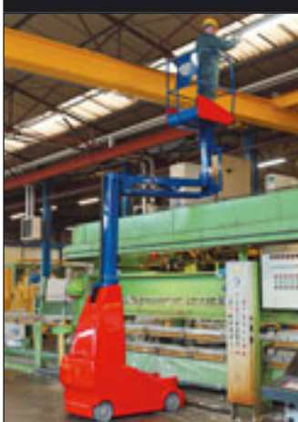
Der Turbo Lift F7 bietet sieben Meter Arbeitshöhe bei einem Eigengewicht von 1050 Kilogramm
