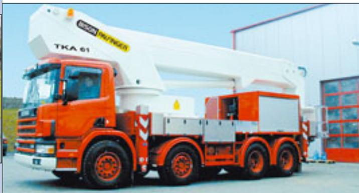
Das erste neue Gerät unter dem Namen Bison Palfinger ist gleichzeitig das größte Gerät aus der LKW-Arbeitsbühnenreihe des Herstellers. Die TKA 61 KS, hier ein Bild der ersten Maschine, verfügt über eine Arbeitshöhe von 61 Metern. Aufgebaut auf ein 32-Tonnen-Chassis, erreicht die Arbeitsbühne eine seitliche Reichweite von 34 Metern bei voller Korblast von 350 Kilogramm. Bei maximaler Reichweite von 39 Metern steht noch eine Korblast von 120 Kilogramm zur Verfügung.
