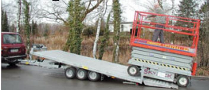
Einen so genannten Kipprahmenanhänger zum Transport speziell von leichten Bühnen hat Ruku Anhängerbau aus Rheinau-Freistett entwickelt. Die Nutzlast des nur 60 Zentimeter Ladehöhe betragenden Gerätes liegt bei 2,8 Tonnen, das zulässige Gesamtgewicht bei 3,5 Tonnen, ideal für größere Geländewagen und ähnliche Fahrzeuge. Laut Hersteller ist es durch die hydraulische Kippeinrichtung, den automatisch versenkbaren Beleuchtungsträger sowie die vorhandene Elektroseilwinde kein Problem, eine Bühne
