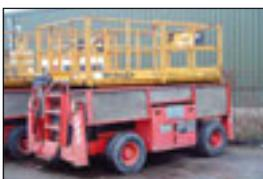
**Scherenbühne Grove SM 4688XT, Bj: 1997**, Arbeitshöhe: 14,20 m, Korbmaße: 4,20x2,32 m, Hublast: 680 kg, Gewicht: 4.800 kg, Diesel, Allrad, verschiebb. Plattform.
