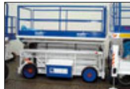
**Scherenbühne Holland Lift H 108 EL 16, Bj: 1990**, Arbeitshöhe: 12,60m, Korbmaße: 3,22x1,54 m, Hublast: 500 kg, Gewicht: 4.570 kg, Batterie, verschiebb. Plattform.
