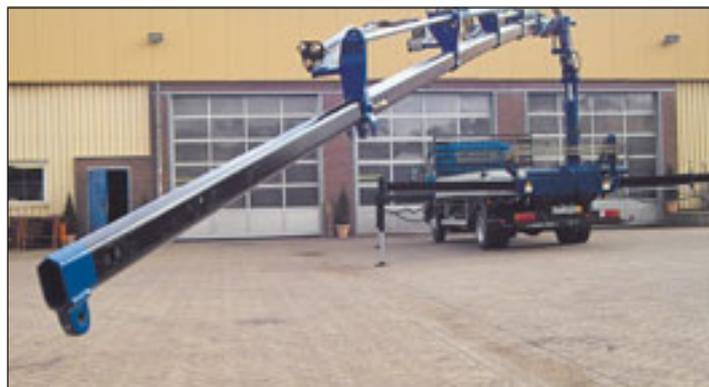
Ein Kunde forderte von Tirre eine große Reichweite des Ladekranes in Verbindung mit einer möglichst hohen Nutzlast für die Ladepritsche auf dem Leicht-Lkw. Als optimales Fahrzeug für den Aufbau mit einem Euro 111 Kran stellte sich ein Mitsubishi Canter Typ HD heraus. Tirre Krantechnik konstruierte einen extrem leichten Hilfsrahmen aus hochfestem Stahl für diesen speziellen Aufbau, um dieses Ziel zu erreichen.
