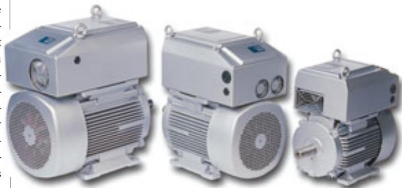
Kompaktantriebe von Emotron bestehen aus einem Motor und einem Frequenzumrichter in einer robusten Einheit. CDX Compact Drives richten sich auch an die Hersteller von Kranen. Vorteile laut Anbieter sind: geringe Kosten für Investition, Installation und Wartung, automatischer Schutz vor Über- bzw. Unterlast, umfassende Drehzahl- und Drehmo-
