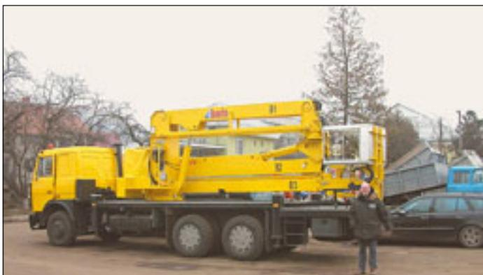
**Der italienische Hersteller Barin lieferte ein Brückeninspektionsgerät AB13/4 S in die Ukraine. Es ist aufgebaut auf einem MAZ-Lkw-Fahrgestell, das in Weißrußland gefertigt wurde, die aufgebaute Plattform kann sowohl nach unten als auch nach oben arbeiten. Reichweite unter Brücke seitlich bis 13 Meter, Reichweite nach unten 15,5 Meter, nach oben 12 Meter.**
