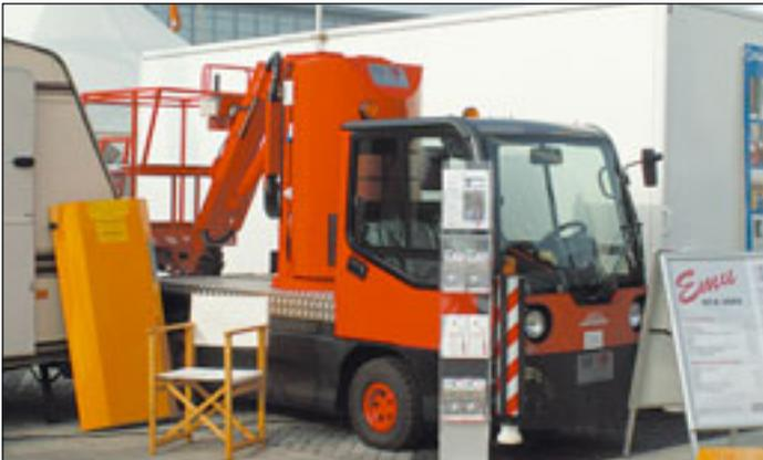
Ein Hingucker, eine ST-K 1003 von EMU auf einem Spezialfahrzeug von Linde. Diese „Mini-LKW-Bühne“ kommt innerhalb von Werksgeländen zum Einsatz.
