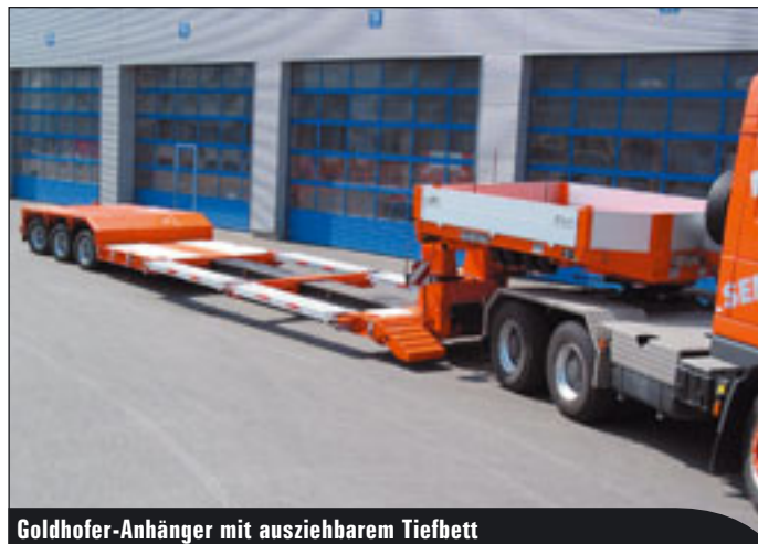
Goldhofer-Anhänger mit ausziehbarem Tiefbett
