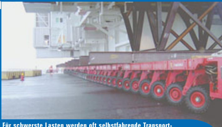
Für schwerste Lasten werden oft selbstfahrende Transport-Module eingesetzt, die vernetzt gesteuert werden müssen.
