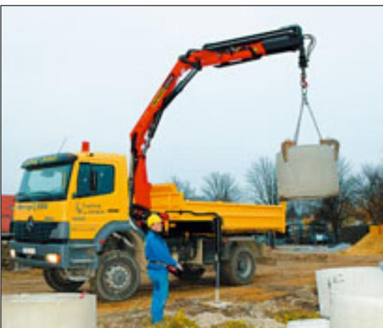
Mehr Hubkraft in der acht- und zehn- Metertonnenklasse; das sollen die neuen Ladekrane von Palfinger, der PK 8501 und der 10501 laut Hersteller bringen. Geeignet für den Baustoffhan-
