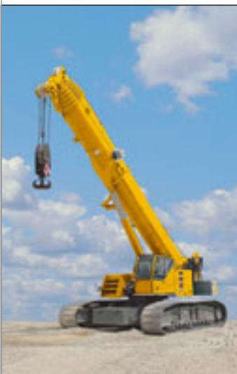
Mit dem LTR 1100 bringt Liebherr einen Teleskop-Raupenkran auf den Markt. Neben 100 Tonnen Traglast verfügt das neue Modell über einen 52 Meter langen Teleskopausleger. Der Kranoberwagen ist weitgehend vom Mobilkran LTM 1100-4.1 übernommen, das Raupenfahrwerk und der Ballast stammen vom Raupenkran LR 1100. Der neue LTR 1100 vereinigt laut Hersteller die Vorteile des Teleskopkranes und des Raupenkranes.
