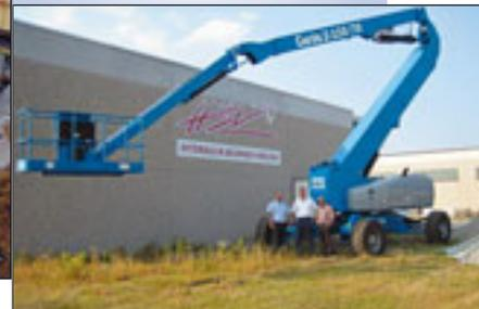
Die Gelenkteleskoparbeitsbühne des Typs Z-135/70 wurde erstmalig in Deutschland von Genie an die Hydraulikbühnenverleih (HBV) GmbH mit Sitz in Spelle verkauft. Das neue Gerät soll je nach Bedarf bei den Kunden von HBV europaweit eingesetzt werden. Die Bühne verfügt über eine Arbeitshöhe von 43,2 Metern, eine seitliche Reichweite von 21,3 Metern, einen Gelenkpunkt bei 23 Meter sowie einen Arbeitsbereich unter Nullniveau von 5,87 Meter.
