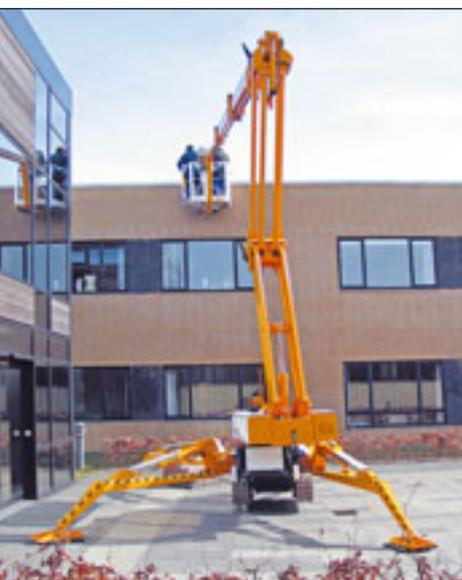
Eine neue Raupenarbeitsbühne bringt Omme auf den Markt. Die 1930 R ist mit einem Scherengelenksystem ausgestattet und hat dadurch eine Reichweite von 10,20 Metern bei einem Gelenkpunkt von zehn Metern bei voller Korblast von 200 Kilogramm. Die Gesamtlänge des Gerätes beträgt 5,9 Meter, die Breite 1,1 und die Bauhöhe 2,07 Meter. Die variablen Stützen erlauben die Aufstellung der Bühne auch bei großen Höhenunterschieden wie im Hügelgelände, bei Treppen oder an Absätzen.
