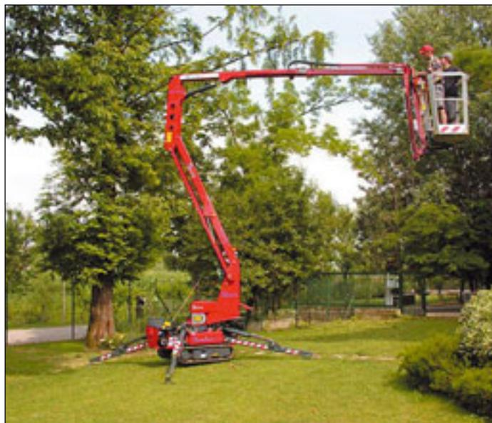
Raupenfahrgestell von 78 auf 108 Zentimeter für optimale Fahrstabilität auch in unwegsamem Gelände, Turmdrehung mittels nachstellbarem Schneckenantrieb, Korblastüberwachung bei
