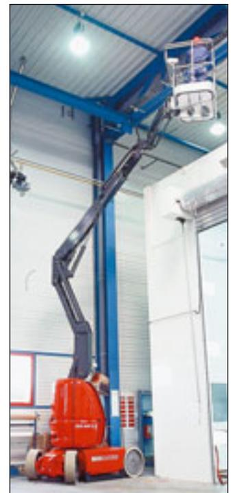
Als Neuheit wird hier das Vorserienmodell einer neuen Maschine ausgestellt, die 150 AETJ. Es handelt sich um eine Bühne mit 15 Metern Arbeitshöhe bei 1,75 Metern Breite und 230 Kilogramm Korbtraglast. Sie baut auf dem Konzept der 120 AETJ auf, mit der sie das Bedienpult teilt. Weiter werden unter anderem ein MRT 2150, ein MT 1740 (beide mit Bühne), verschiedene Geräte der AETJ-Reihe sowie auch ein
