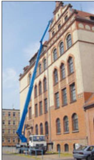
Präsentation des LKW- Bühnenprogramms, speziell der so genannten Kompaktklasse auf einem 7,49 Tonnen Fahrgestell. Dazu gehören neben anderen WT 300 sowie die WTB 220. Alle sind mit beweglichem Korbarm ausgestattet und erreichen Arbeitshöhen von 22 bis 30 Metern. Eine Klasse darüber arbeitet die WT 450 mit 45 Metern. Alle sind mit einer CAN-Bussteuerung versehen, die sowohl halbautomatische Abstützung sowie ein Einfahren in die Grundstellung (Home-Funktion) auf Knopfdruck ermöglicht.
