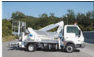
Hersteller von Bühnen auf LKW-Basis von 18 bis 85 Metern Arbeitshöhe. Neue Gelenkteleskopbühne mit 20 Metern Arbeitshöhe auf 3,5 Tonnen Fahrgestell. Reichweite 9,15 Meter.
