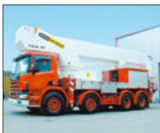
Die Fahrzeuggesamtlänge beträgt elf Meter bei einem Radstand von nur 4,5 Metern. Weiter wird die kompakte „Stadtbühne“ TKA 28 KS mit einer Länge von 6,8 Metern bei nur drei Metern Radstand zu sehen sein.
