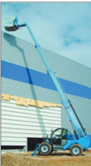
Umfangreiche Auswahl an neuen Bühnen, so die Z-51/30 JRT und die neue Z-135/70 mit einer maximalen Arbeitshöhe von 43,2 Metern und einer übergreifenden Höhe von 23 Metern nach vorne. Weiter
