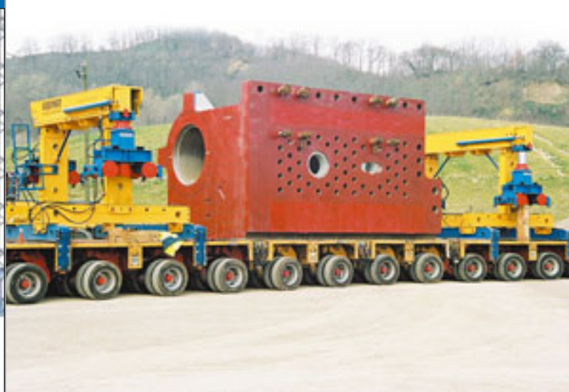
Der so genannte „Beaver“ (Biber) von Scheuerle ist ein Spezialtransportsystem für den Tunnelbau mit bis zu 100 Tonnen Nutzlast, das sich aus zwei Fahrzeugeinheiten zusammensetzt. Diese sind durch eine Zug- und Schubstange miteinander mechanisch/elektronisch verbunden und können mit bis zu 30 km/h vorwärts als auch rückwärts fahren.
