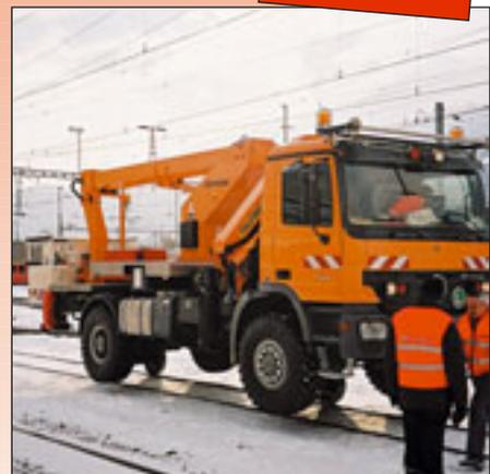
ger-Kran machen das Gerät universal einsetzbar. Um in der Höhe respektive seitlich optimal arbeiten zu können, ist eine Hubarbeitsbühne mit 17 Metern Höhe auf Mercedes-Benz Actros 1832 montiert.
