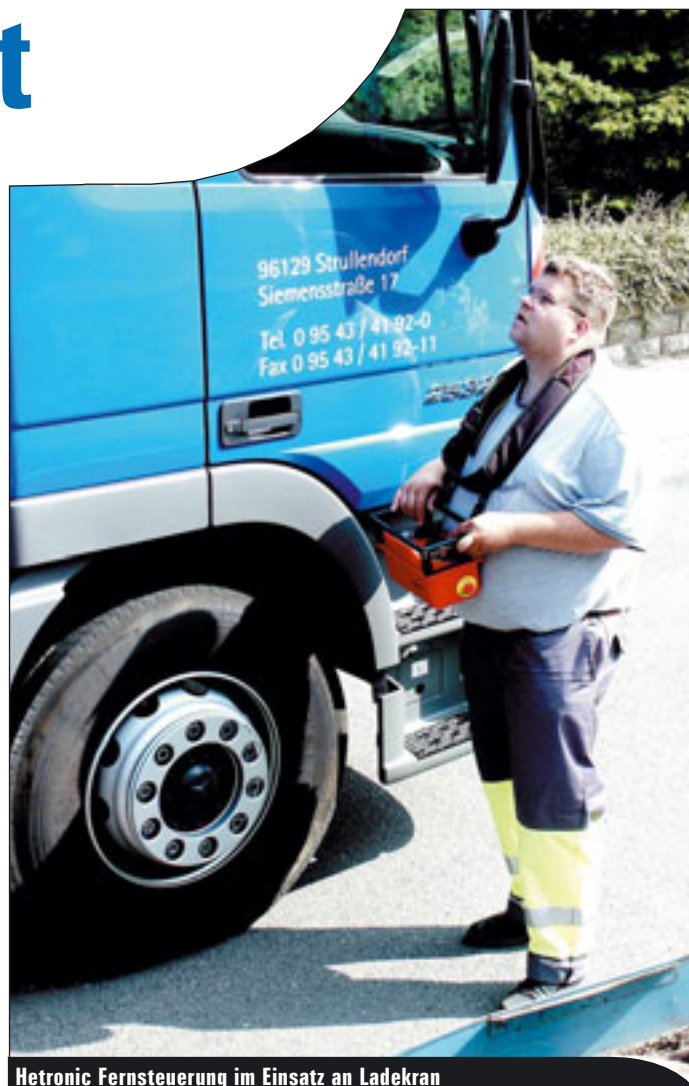
Hetronic Fernsteuerung im Einsatz an Ladekran
