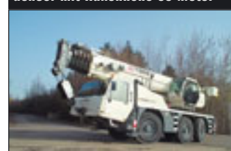
Der Terex Demag AC 55 L Drei- achser mit Hakenhöhe 59 Meter
