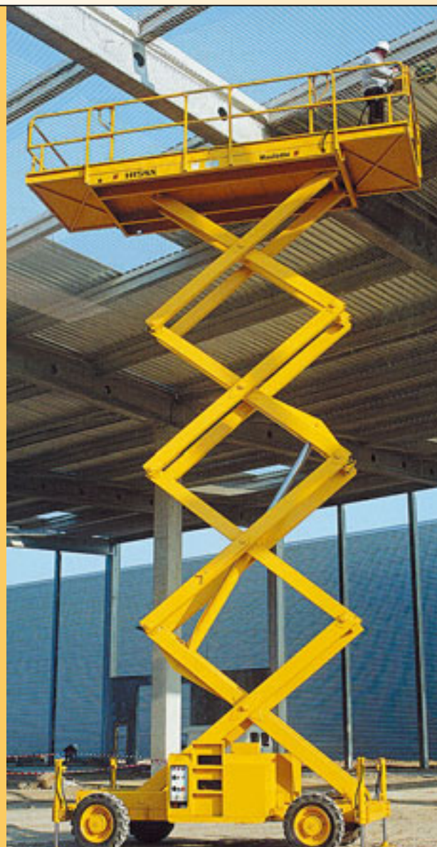
Eine Haulotte Compact-Modell (12 RTE) bei Außenarbeiten
