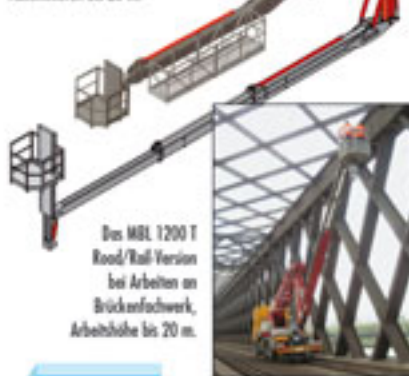
Z.B. die MBL-Gerätereihe für Straße, Schiene und in Road/Rail-Ausführung mit Absenktellen bis 20 m.
