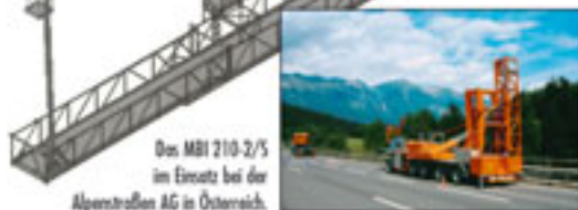
Z.B. Brückenuntersichtgeräte in Plattformbauweise für Inspektion und Sanierung (von 4,5 bis 25 m Arbeitsreichweite).
