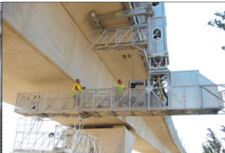
Gerätetyp MBS 90-1,2 im Einsatz bei der französischen Eisenbahn SNCF. Mit dem Brückeninspektionsgerät können bei laufendem Betrieb die Kontrollen und Arbeiten ausgeführt werden.
