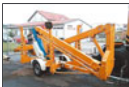
Anhängerbühne Upright TL 49, Bj: 1997 , Arbeitshöhe: 17,00 m, seilt.Reichweite: 8,30 m, Korbmaße: 1,20x0,60 m, Hublast: 215 kg, Gewicht: 1.900 kg, 220 V Antrieb,hydraul. Stützen.
