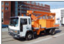
LKW-Teleskopbühne Ruthmann T130 auf Volvo FL 6 11, Bj.: 1986 , Arbeitshöhe: 15,00 m, seilt.Reichweite: 11,00 m, Korbmaße: 1,60x0,80 m, Hublast: 250 kg, Gewicht: 8.000 kg, Diesel, hydraul. Stützen.
