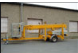
Anhängerbühne Omme Lift 1850 EBZ, Bj: 1998 , Arbeitshöhe: 18,60 m seilt.Reichweite: 11,70 m, Korbmaße: 1,25x0,80 m, Hublast: 200 kg, Gewicht: 2.180 kg, 220 V Antrieb, hydraul. Stützen.
