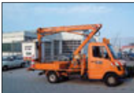
LKW-Teleskopbühne Ruthmann KS 90 auf MB 307, Bj.: 1988 , Arbeitshöhe: 11,00 m, seilt.Reichweite: 5,80 m, Korbmaße: 1,20x0,60 m, Hublast: 150 kg, Gewicht: 3.500 kg, Diesel, hydraul. Stützen.
