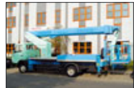
LKW-Teleskopbühne Ruthmann T 245 auf MB 814, Bj.: 1995 , Arbeitshöhe: 26,00 m, seilt.Reichweite: 17,50 m, Korbmaße: 1,70x1,00 m, Hublast: 265 kg, Gewicht: 7.490 kg, Diesel, H-Stützen, Korbbarm
