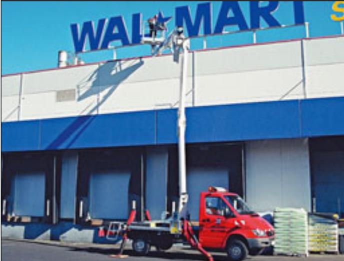
CTE Z 20 („City-Ranger“) auf Sprinter-Basis ein. Die seitliche Reichweite von fast zehn Metern war bei dieser Fassade, die Vordächer und hohe Störkanten aufwies, einer der Gründe zur Entscheidung gerade für diesen Typ. Eine Gerüsterstellung kam wegen des regen Fußgängerverkehrs und des laufenden Bahnhofbetriebs von vornherein nicht in Frage, beschrieb Harald Ziegler die Rahmenbedingungen für die Anmietung.
