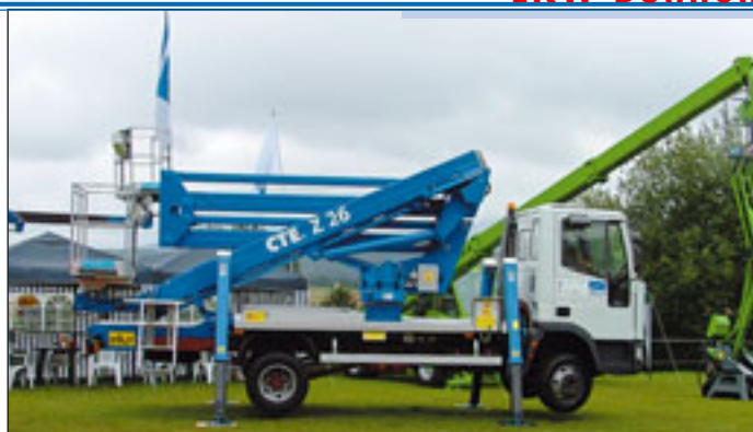
Die neue CTE Z 26 bietet bei einem Gelenkpunkt von rund elf Metern eine Reichweite von 12,4 Metern
