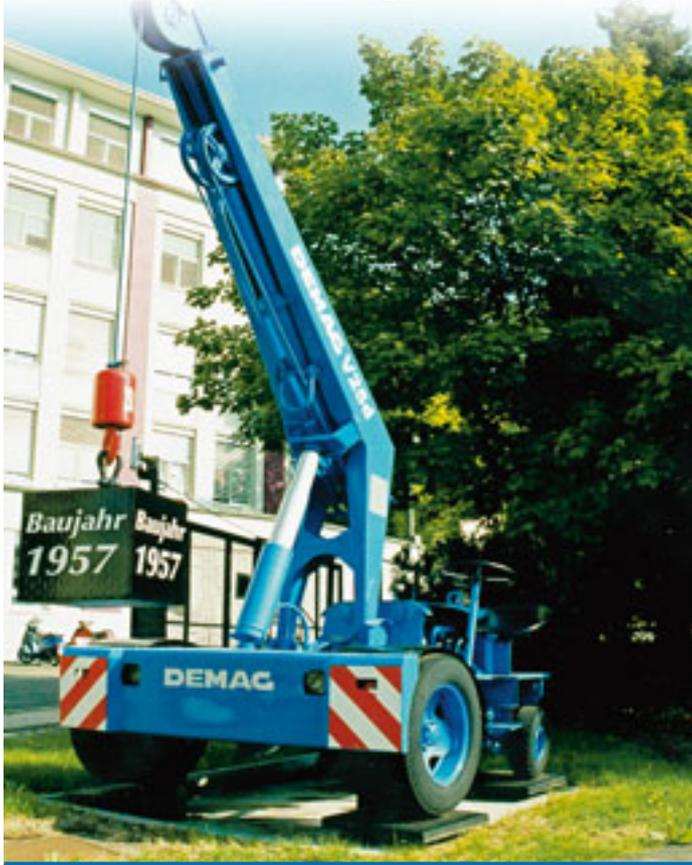
In voller Pracht strahlt dieser Demag V25d wieder. Vor den Toren des Zweibrückener Unternehmens Terex-Demag präsentiert sich dieser Zweiachser aus dem Jahre 1957. Das Vorgängermodell der V 2500 war der erste Teleskopkran aus der Dinglerstraße im Saarland. Eine Last von 2,5 Tonnen haben die Krane seinerzeit am Haken bewegen können.
