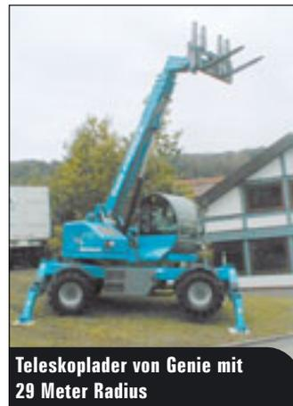
**Teleskoplader von Genie mit 29 Meter Radius**
